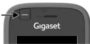
Στο πλήκτρο λειτουργίας μπορεί να αντιστοιχιστεί μια λειτουργία της επιλογής σας (Πλήκτρο Κλήσης / Συντομ. / Πλήκτρ.Ειδοποίησ/ / Λειτουργία συστ. και άλλες λειτουργίες ανάλογα με το σταθμό βάσης).
