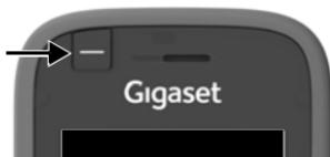
Функциональной клавише можно назначить функцию по своему выбору (Клавиша отправ. / Быст.наб / Клавиша опов. / Функция системы и другие функции в зависимости от базового блока).
