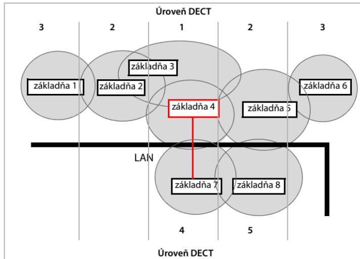
**Konfigurácia:** Zmiešaný scenár. Základňové stanice klastra sú oddelené protipožiarou stenou. Oblast prekrývania môže byť dostatočne veľká na odovzdávanie a výber dynamického kanála, ale nie na synchronizáciu. Preto synchronizácia medzi jednou základňovou stanicou na každej strane protipožiarnej steny prebieha cez sieť LAN. Ďalšia základňová stanica sa synchronizuje prostredníctvom siete DECT. Kedže LAN Master musí byť na úrovni DECT 1, základňová stanica 4 sa používa ako LAN Master.
