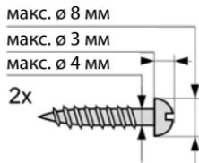
Для крепления устройства к стене используются два винта.
