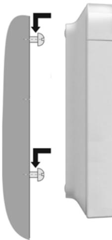
Для крепления устройства к стене используются два винта.
