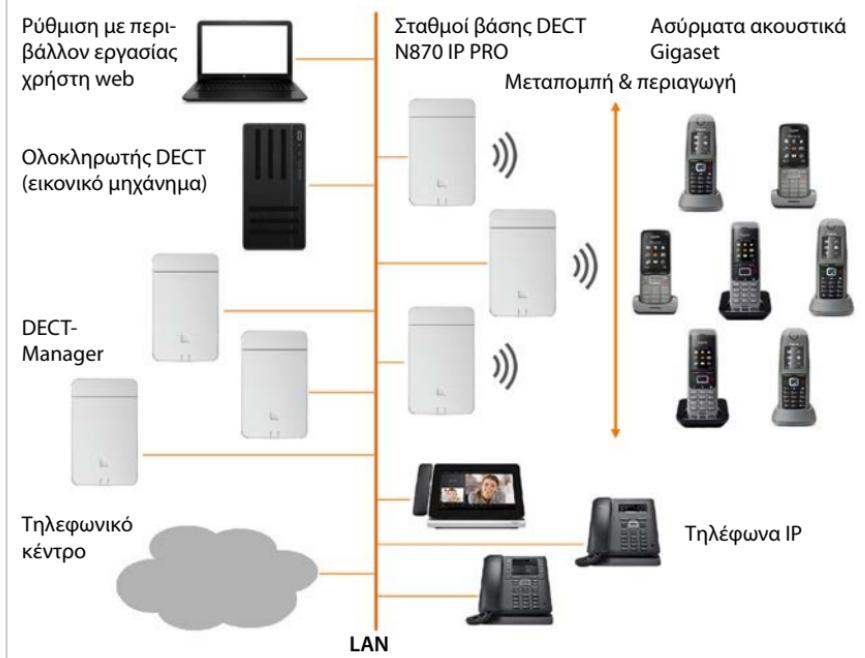
Σε μια μεγάλη εγκατάσταση ο ολοκληρωτής παρέχεται ως ανεξάρτητο μέρος του συστήματος. Ολοκληρωτής απαιτείται, όταν:
