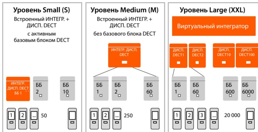
ИНТЕГР. = интегратор, ДИСП. DECT = диспетчер DECT, ББ = базовый блок
