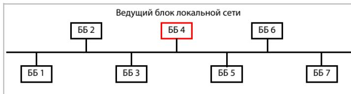
**Конфигурация.** Простая синхронизация по локальной сети с базовым блоком 4 в качестве ведущего. Уровень синхронизации по DECT-сети не имеет значения.
