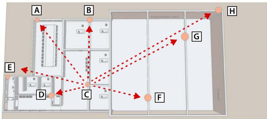
**Υπόδειγμα ενός πρωτοκόλλου μετρήσεων για τη μέτρηση της αλληλοκάλυψης συγχρονισμού**
