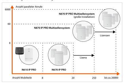
N610 IP PRO Einzelzelle, 8 Mobilteile, 8 parallele Anrufe
