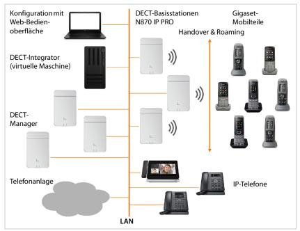
In einer großen Installation steht der Integrator als eigene Systemkomponente zur Verfügung. Ein Integrator wird benötigt, wenn:
