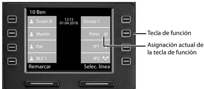
Asignar las teclas de función con el configurador web: → p. 45
