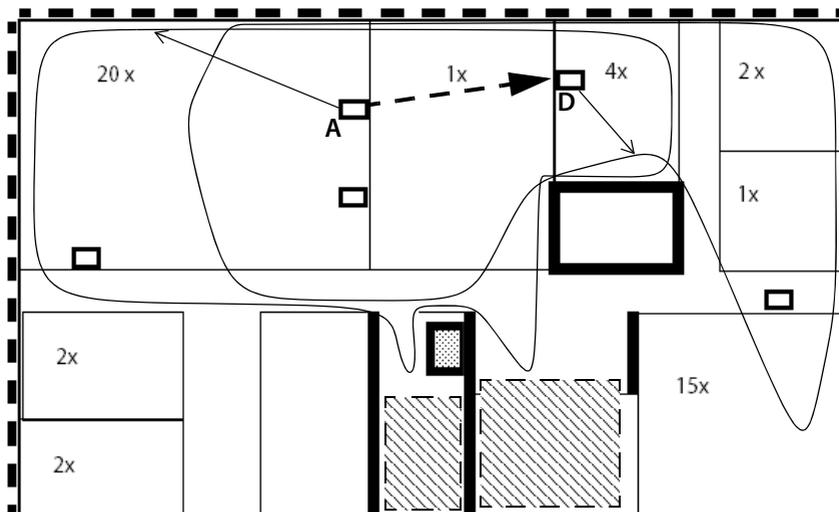
En el ejemplo, se han dibujado líneas de límite de cobertura de radio para las estaciones base A y D. Las zonas de solapamiento son muy buenas para ambas estaciones y la sincronización entre A y D está siempre garantizada. No obstante, según los resultados de medición del resto de estaciones debe comprobarse si es necesaria otra estación base en las zonas sombreadas.
