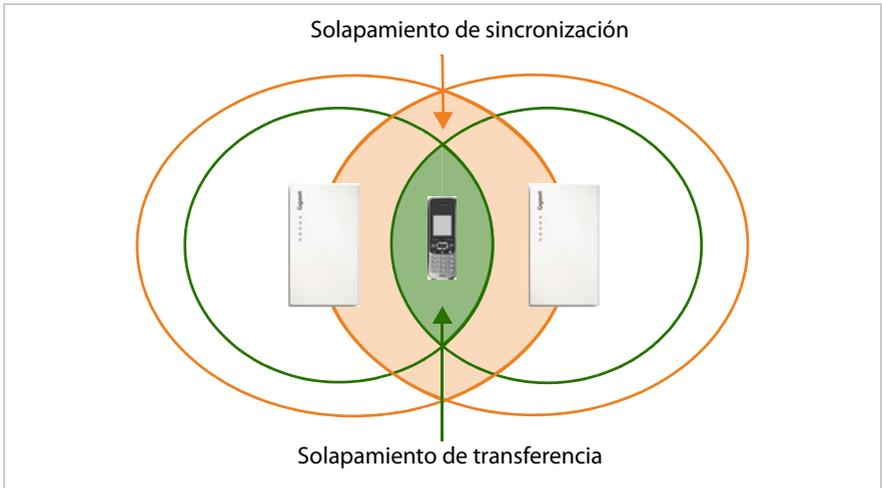
Hay que prestar atención a que existan zonas de solapamiento suficientemente grandes entre células inalámbricas vecinas. Para la sincronización, la recepción debe ser lo suficientemente buena como para que las estaciones base reciban con seguridad entre sí. Para la transferencia, un terminal inalámbrico debe tener conexión con ambas estaciones base con suficiente calidad. Encontrará información acerca de los valores necesarios en el párrafo **Determinación de los valores límite**, → p. 21.
