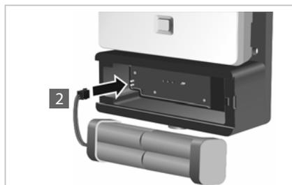
**Atención:** el conector está diseñado de manera que sólo se puede conectar de la manera correcta. Si se conecta a la fuerza el conector en la posición errónea, se dañarán los pines y el dispositivo no funcionará.
