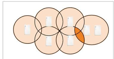
Per mantenere bassi i costi per i dispositivi così come per l'installazione e la manutenzione, vanno installate meno stazioni base possibili.
