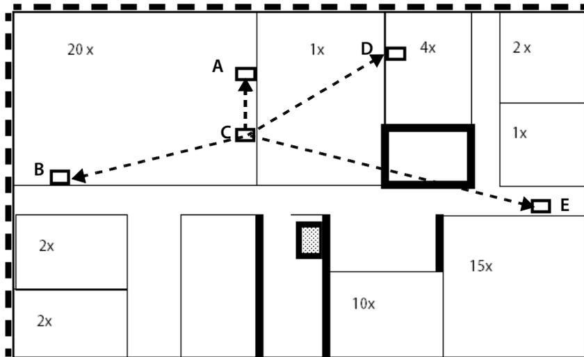
**Esempio di protocollo delle misure per la misurazione della sovrapposizione della sincronizzazione**
