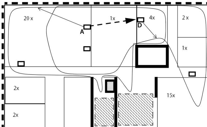
Nell'esempio per le stazioni base A e D sono tracciate le linee di confine per la copertura radio. Le aree di sovrapposizione sono molto buone per entrambe le stazioni, la sincronizzazione tra A e D è altrettanto garantita. Va comunque verificato, in base ai risultati delle misurazioni delle ulteriori stazioni, se nelle aree tratteggiate è necessaria un'ulteriore stazione base.
