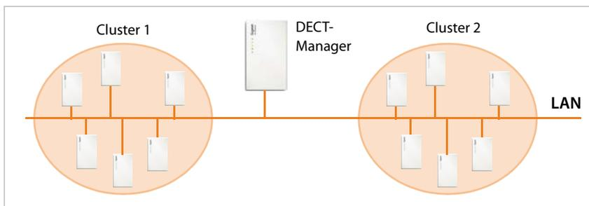
Il DECT-Manager è collegato alle stazioni base e al centralino telefonico tramite la rete locale e non dipende quindi dalla copertura DECT. Nel vostro ambiente è perciò possibile installare isole DECT separate tra loro, che vengono comunque gestite centralmente, cioè che hanno accesso alle configurazioni IP configurate centralmente, alle rubriche telefoniche etc.
