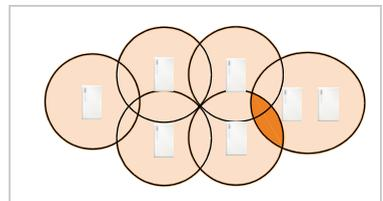
Pour minimiser les frais pour les appareils aussi bien pour l'installation que pour l'entretien, il est nécessaire d'installer aussi peu de stations de base que possible.
