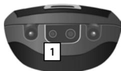
È possibile collegare, nell'apposita presa situata sul lato inferiore del portatile, un auricolare telefonico a filo dotato di spinotto jack da 2,5 mm [1]. Il volume dell'auricolare si regola come quello del ricevitore e le impostazioni si equivalgono.
