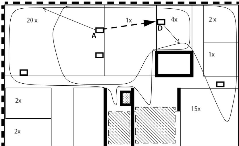
Dans l'exemple, les lignes de délimitation pour la couverture radio sont dessinées pour les stations de base A et D. Les zones de chevauchement sont excellentes pour les deux stations, la synchronisation entre A et D est également garantie. Il faut toutefois vérifier si, à l'aide des résultats de mesure des autres stations, une autre station de base s'avère requise dans chaque zone barrée.
