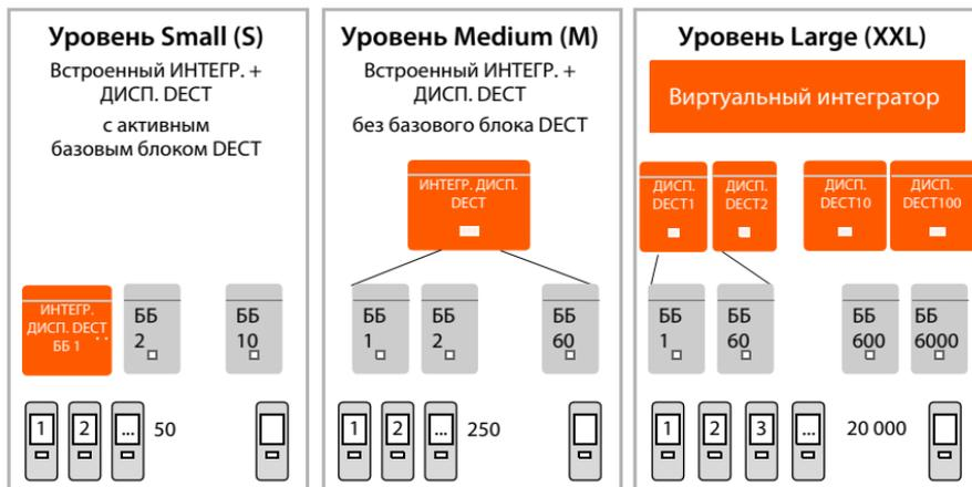
ИНТЕГР. = интегратор, ДИСП. DECT = диспетчер DECT, ББ = базовый блок
