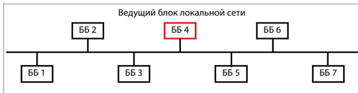
**Конфигурация.** Простая синхронизация по локальной сети с базовым блоком 4 в качестве ведущего. Уровень синхронизации по DECT-сети не имеет значения.
