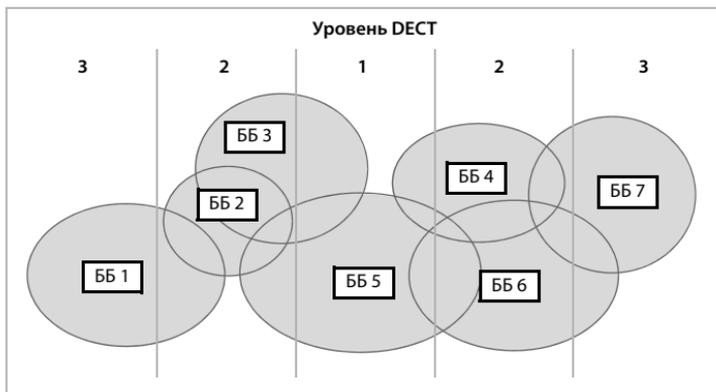
**Конфигурация.** Синхронизация только по DECT-сети. Каждый базовый блок может синхронизироваться с каждым базовым блоком с более высоким уровнем синхронизации. При наличии нескольких доступных базовых блоков используется базовый блок с более мощным сигналом. Базовый блок в центре кластера расположен на уровне 1 DECT-сети. Это сокращает количество необходимых уровней синхронизации.
