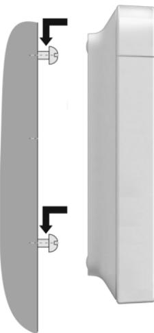
Upevnite zariadenie na stenu pomocou dvoch skrutiek:
