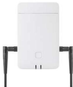
Los dispositivos de tipo N870E IP PRO se suministran con dos antenas externas.
