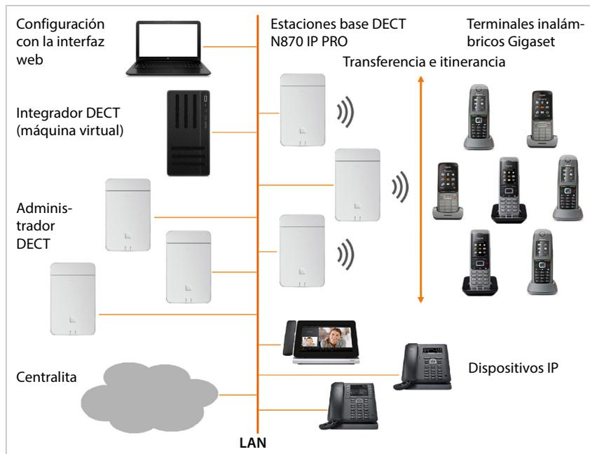
En una instalación grande, el integrador está disponible como componente del sistema propio. Se necesita un integrador cuando:
