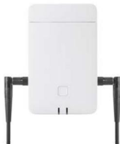
Dispositivos do tipo N870E IP PRO são fornecidos com duas antenas externas.
