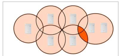
Um die Kosten für die Geräte sowie für Installation und Wartung gering zu halten, will man typischerweise die Anzahl der Basisstationen so gering wie möglich halten. Trotzdem müssen so viele wie nötig zur Sicherung der Kapazität und Funkabdeckung geplant werden.
