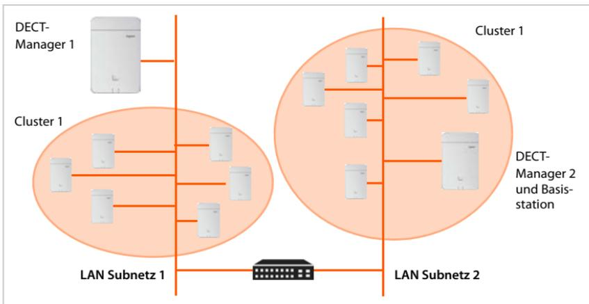
In Installationen mit mehreren DECT-Managern ist Handover und Roaming zwischen Basisstationen verschiedener DECT-Manager möglich, wenn die Cluster synchronisiert sind. Lastausgleich ist nicht möglich. Beachten Sie die Hinweise im Abschnitt **Einsatz mehrerer DECT-Manager** → S. 16.
