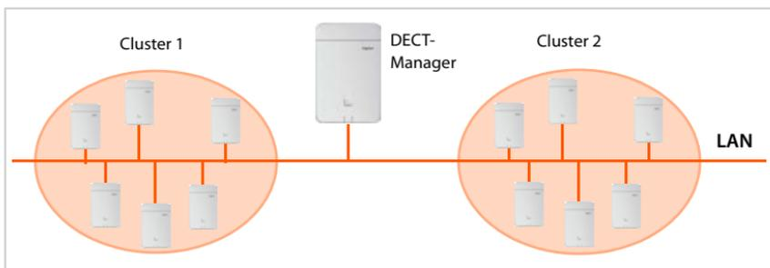
Für Installationen in verschiedenen LAN-Subnetzen benötigen Sie mehrere DECT-Manager mit einem DECT-Manager pro Subnetz. Die DECT-Manager-Rolle kann abhängig von der Kapazität der lokalen Basis parallel auf dem gleichen Gerät installiert sein. Mehrere DECT-Manager benötigen Sie auch, wenn Sie mehr als 250 Mobilteile anschließen oder mehr als 60 Verbindungskanäle bereitstellen wollen.
