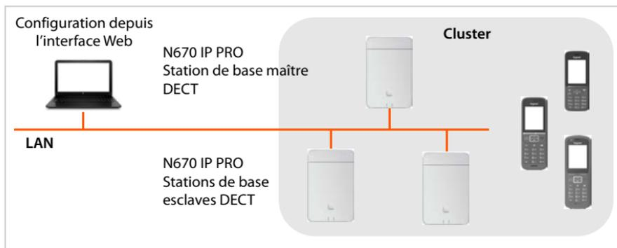
Tous les appareils N670 IP PRO forment un cluster et se synchronisent les uns avec les autres, afin de permettre le transfert, le roaming et le transfert de charge. La synchronisation se déroule via DECT ou LAN. Jusqu'à huit conversations simultanées sont possibles.
