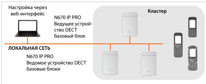
Все устройства N670 IP PRO формируют кластер и синхронизируются для передачи вызовов, роуминга и распределения нагрузки между телефонными трубками. Синхронизация выполняется по сети DECT или локальной сети. Поддерживаются до 8 одновременных вызовов.
